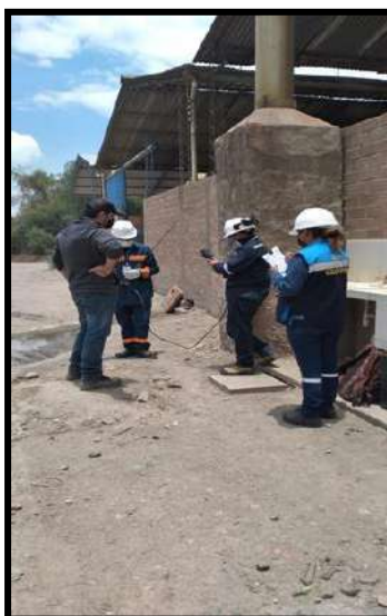
Fotografía 18. Monitoreo de emisión de gases caldero industria REFRAK
