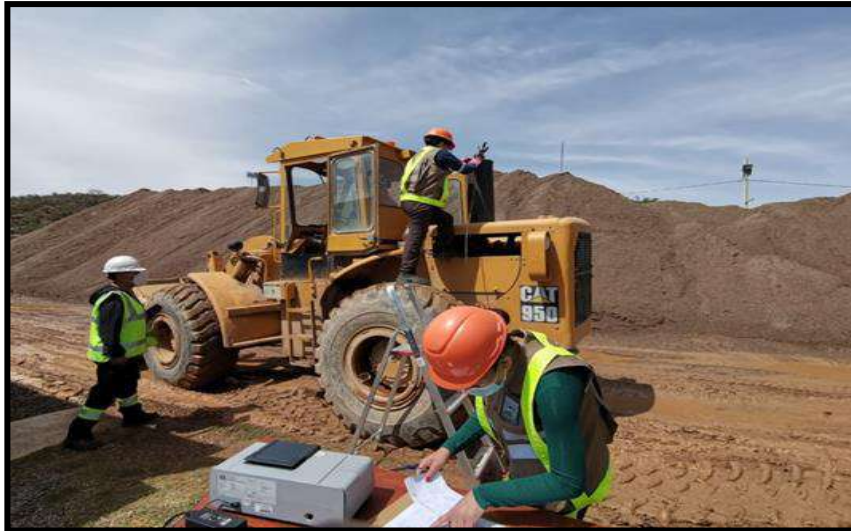
Fotografía 14. Medición emisión de gases a la Empresa Socobe a solicitud
